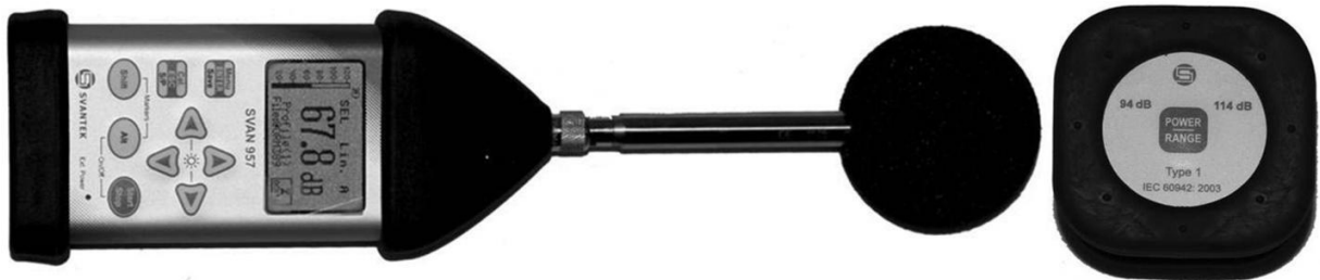
40 pav. SVAN 957 Triukšmo ir vibracijos matuoklis.
